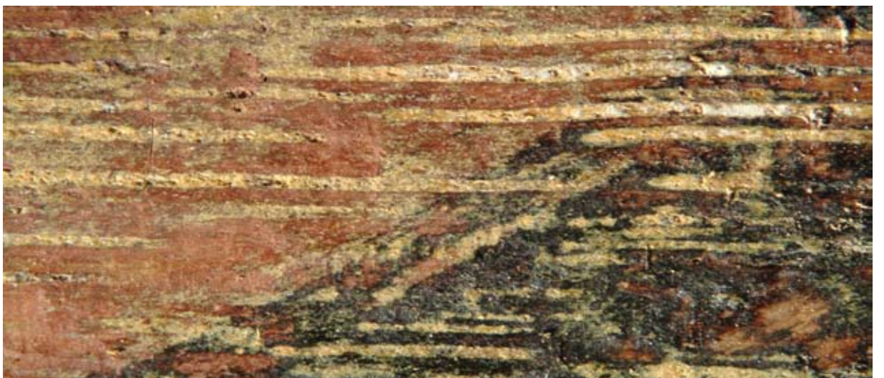
DETAIL SCHIDERING (30x) OVSCHILDERING MECHANISCH VERWIJDERD
